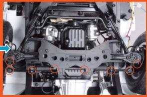
從背面觀看,將前輪胎完全轉向右側,然後在〇圈起的可動部位 塗抹潤滑劑。
