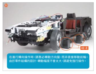
為了避免對轉向結構造成負擔,將底盤放置在第42期提供的4個底盤支座 42-E 上。左右轉動方向盤,確認前輪是否同步轉動。
