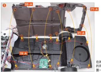
在將內裝與底盤組裝之前,請先確認地板底板 55-A 和後方地板底板 71-A 的背面,以及車身淺盤型地板 19-A 和後地板面板 21-A 上各自的螺絲孔位
