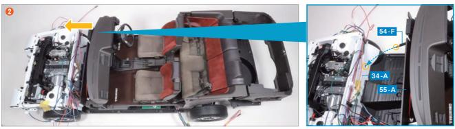
首先,將安裝在艙壁隔板 34-A 背面的配線連接器部分向上抬起,避免夾在 55-A 的前部。接著,將方向盤軸 54-F 插入 34-A 的洞孔中,然後對齊在步驟 ① 中確認的內裝與底盤的12個螺絲孔位置。
