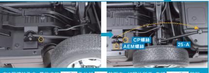
在8個螺絲孔中,最後方的 CP螺絲 孔位於 25-A 的下方。如照片所示,先將 AEM螺絲 稍微 鬆開,將 25-A 抬起後,再鎖緊 CP螺絲 。之後,將 25-A 恢復原位,並重新使用 AEM螺絲 固定。
