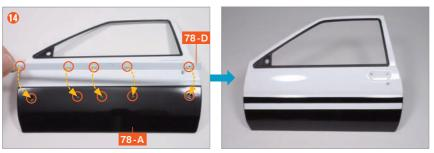
將車門飾條 (L) 78-D 的兩處螺絲孔突起和三處突起,分別對應嵌入前車門 (L) 78-A 的兩處螺絲孔凹槽和三處洞孔。
