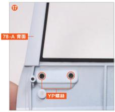
一邊壓住 78-B 以防脫落,一邊將 78-A 翻到背面。使用十字螺絲起子0號,以 YP螺絲 將兩處固定。
