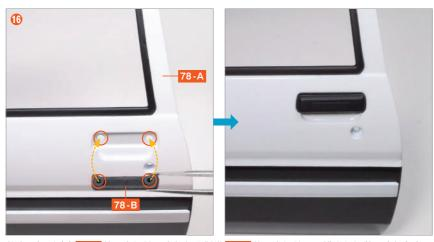
將車門把手(L) 78-B 的兩處螺絲孔突起部分對準 78-A 的兩處螺絲孔凹槽進行組裝。請參考步驟 10 的照片,確認 78-B 的上下方向。
