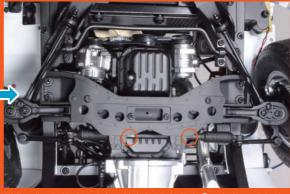
從背面觀看,將前輪胎完全轉向左側,然後在〇圈起的可動部位 塗抹潤滑劑。
