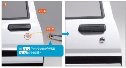
確認車門鎖鑰匙筒(L) 78-C 的螺絲孔突起形狀,然後將其與 78-A 的螺絲孔凹槽對準並組裝。
