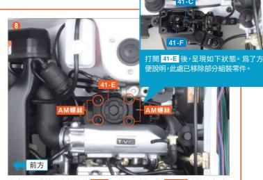
注意不要讓轉向齒輪箱蓋 41-E 脫落,同時將4根 AM螺絲中的前方2根稍微鬆開,後方2根拆下。拆下的 AM螺絲稍後會再次使用。打開 41-E ,拆除冠狀齒輪 41-F 與轉向齒輪軛 41-C 的咬合。
