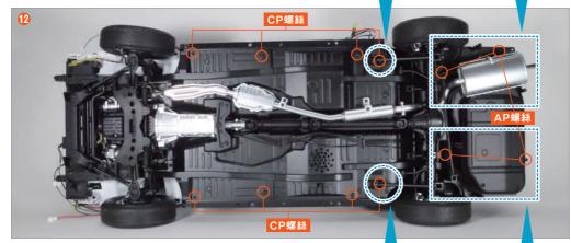
備妥在第77期中存放的 AP螺絲和 CP螺絲。小心將內裝與底盤翻至背面,避免脫落,然後按照照片所示,分別使用AP螺絲 固定4處,CP螺絲 固定8處。
