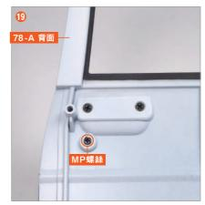
一邊壓住 78-C 以防脫落,一邊將 78-A 翻到背面。使用十字螺絲起子0號,以 MP螺絲 將其固定。
