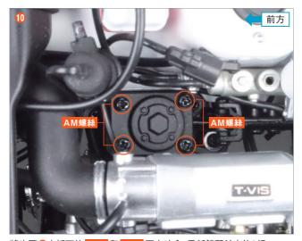
將步驟③中拆下的 41-F 和 41-C 再次咬合,重新鎖緊前方的2根 AM螺絲,然後將後方拆下的2根 AM螺絲 重新鎖緊固定。
